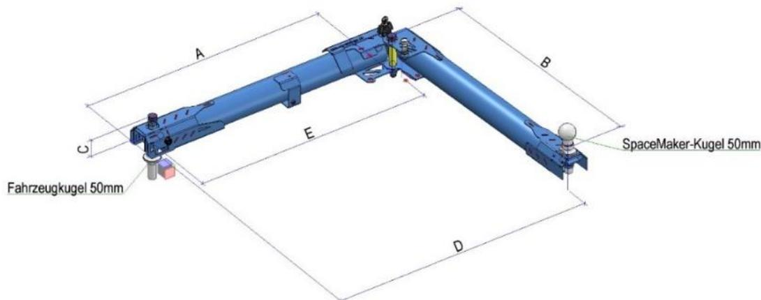
A= 790mm / Achsmass Kugel Fahrzeug zu Drehpunkt SpaceMaker
